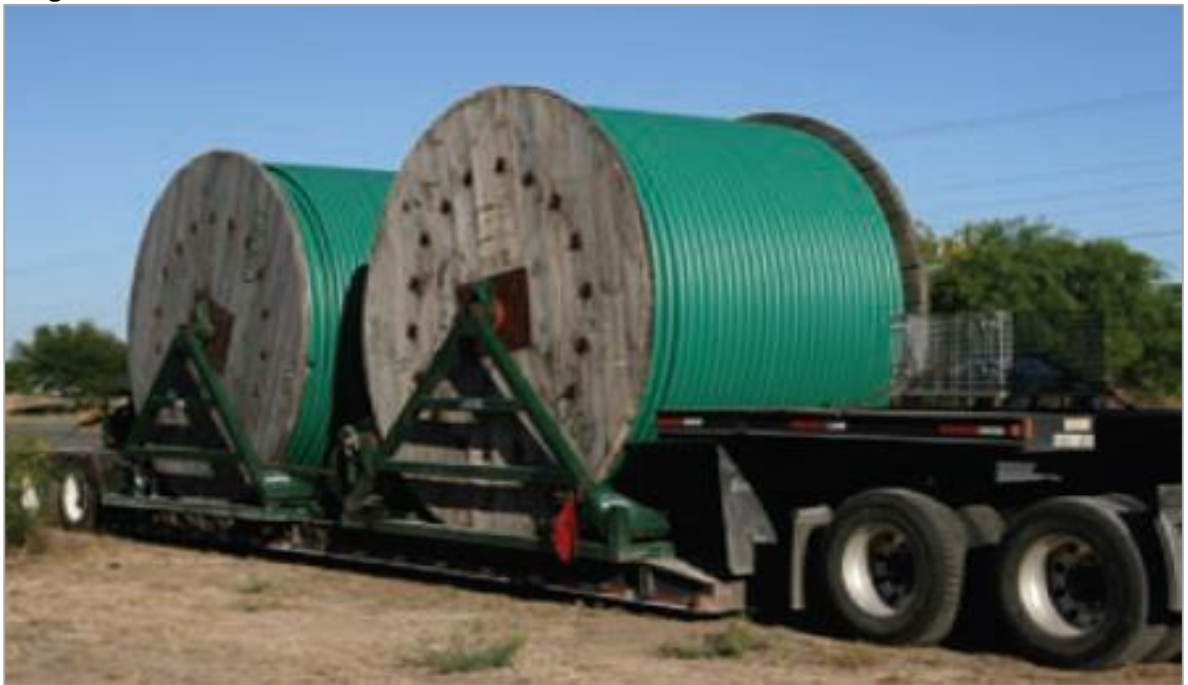
Imagen 1. Correcta movilización de carretes de tubería flexible.
