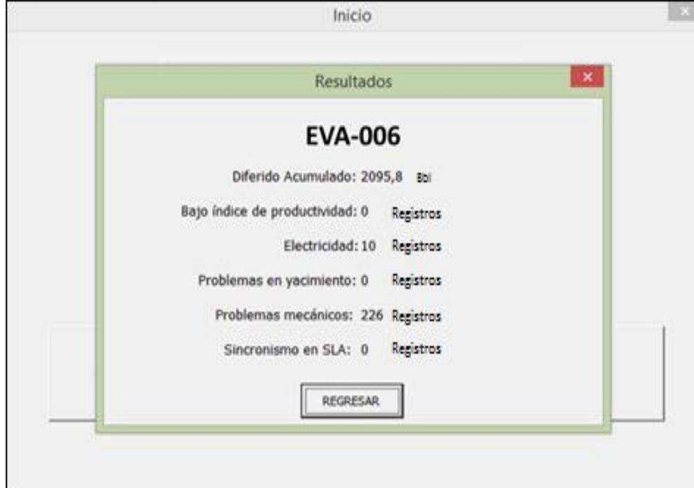
El Pozo Eva-006 posee un potencial que oscila entre los 8 a los 18 BOPD bajo un esquema de bombeo mecánico. Ha presentado diferentes problemáticas, como se muestra a continuación:
